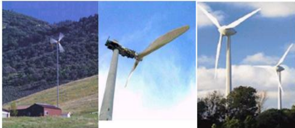
Tripale bipales tripale Excel : 7m-10 KW Ge 220 :220KW E 66 : 65m-1.8Mw
