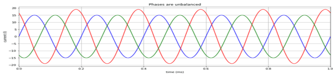
Figure I.3 Déséquilibre du système triphasé de tension
