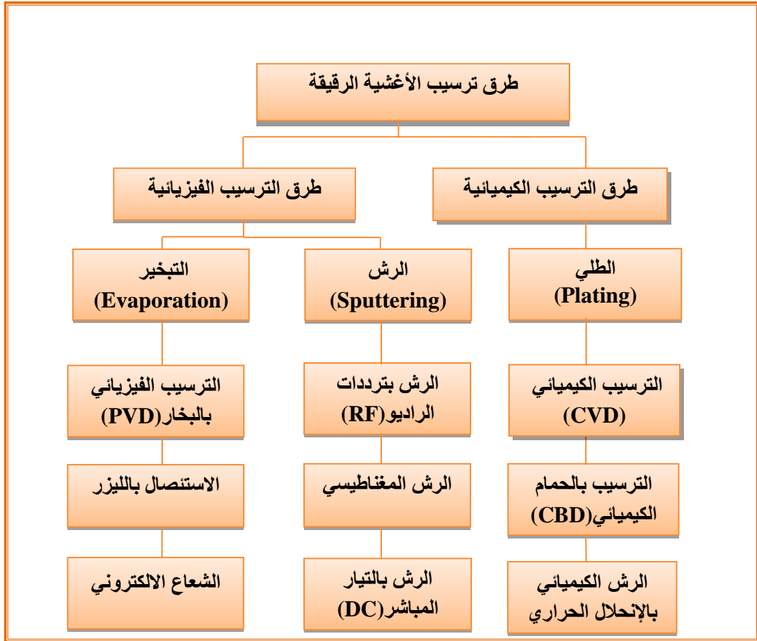
الشكل (1-II): مخطط يوضح التقنيات المختلفة لترسيب الأغشية الرقيقة [16].
