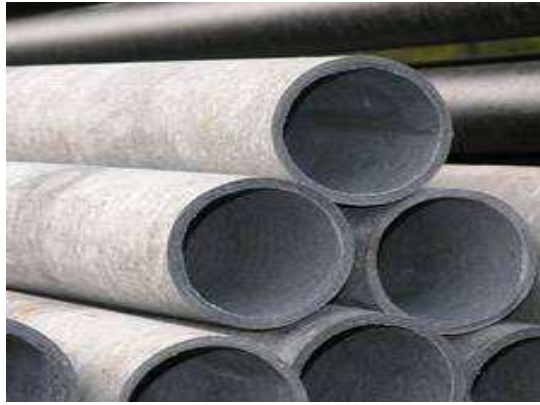
Photo VI.1 : Conduite en amiante ciment.
