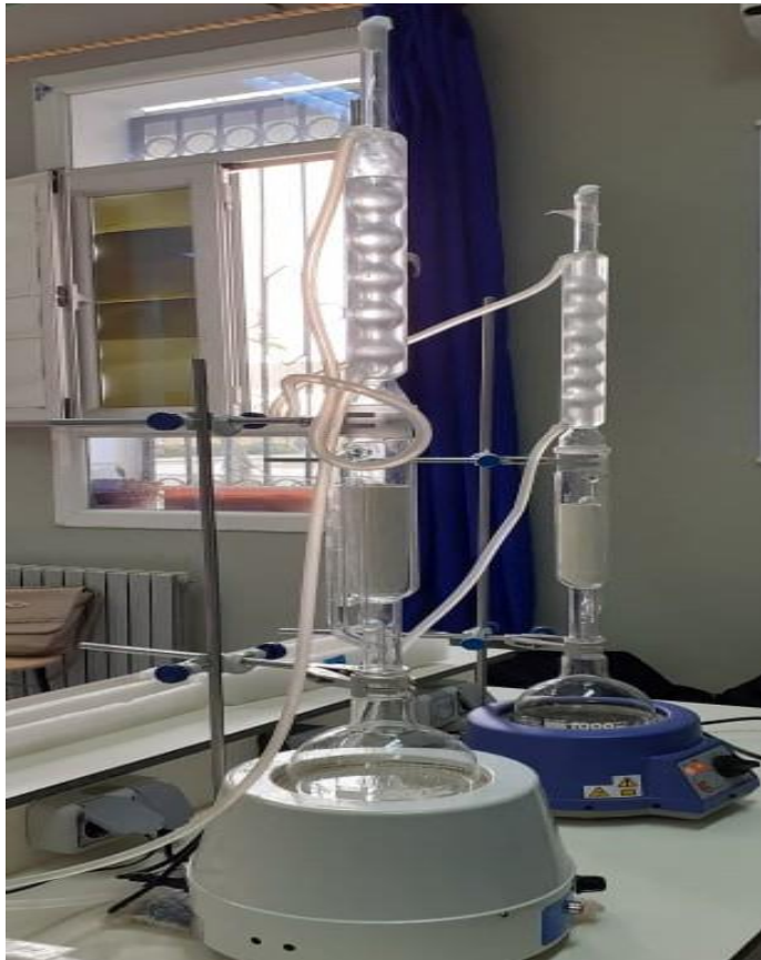
الوثيقة (07): صورة لجهاز Soxhlet المستخدم في استخلاص العينة النباتية.
