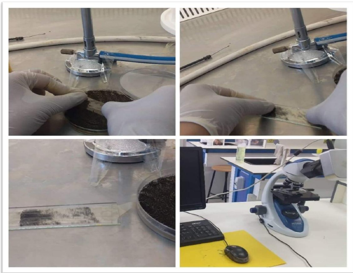
Figure 18: Méthode d'identification microscopique des moisissures par la technique de Scotch
