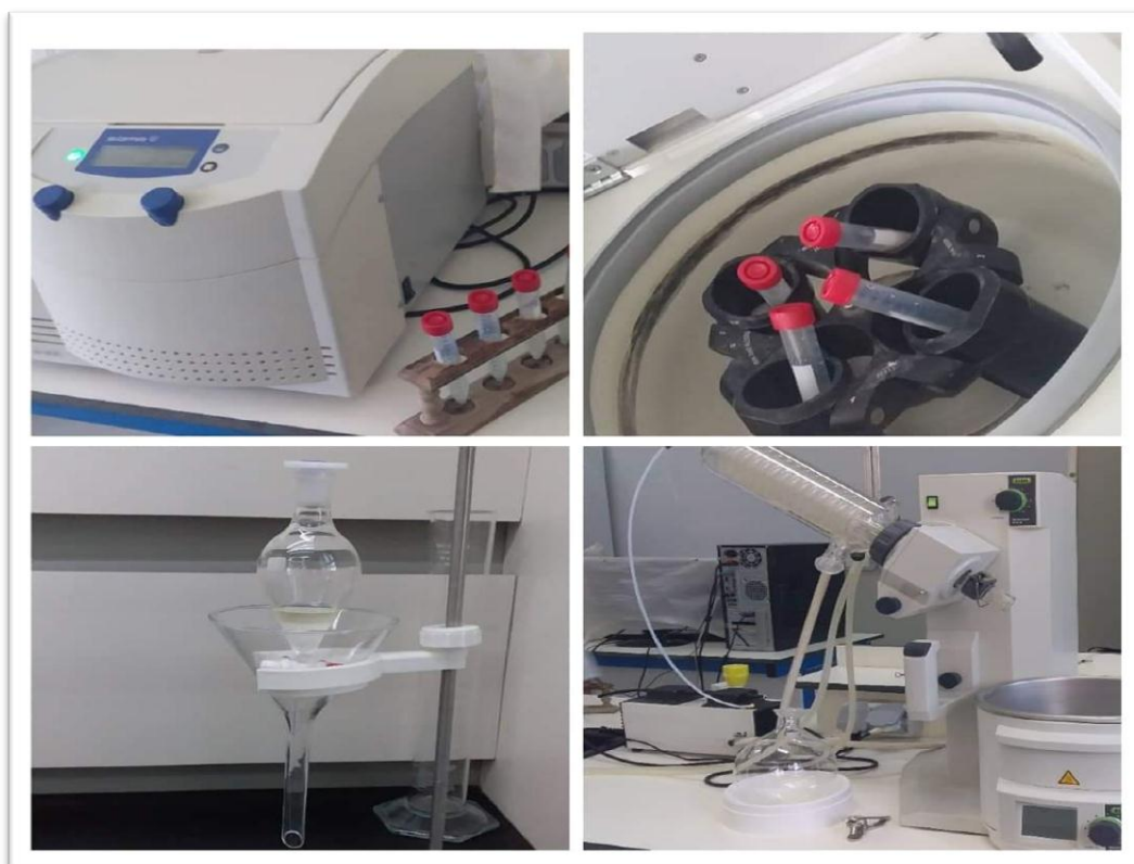
Figure 21: L'extraction de mycotoxine par l'acétate d'éthyle et le chloroforme
