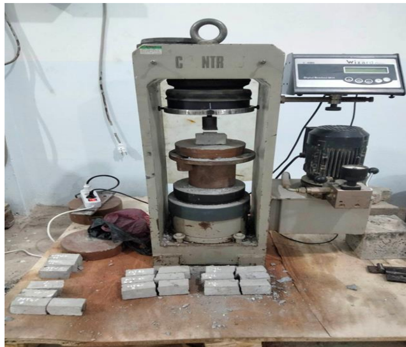
Figure: 2.39 Rupture d'un demi-prisme.
