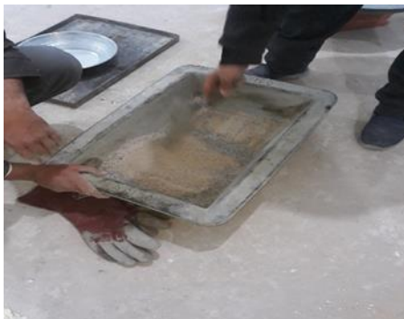
Figure 2.28. Le malaxage à sec des matériaux
