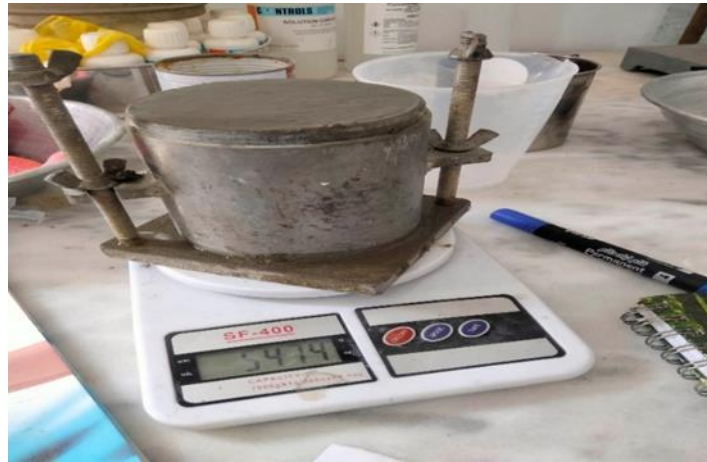
Figure 2.33 Pesage du récipient cylindrique (environ 1 L) avec le béton
