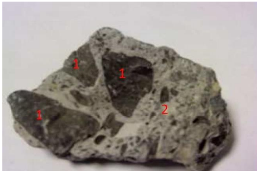
Figure 1.10 – Constitution d'un granulat recyclé de béton [11]
