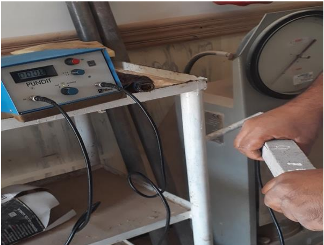
Figure 2.35 Mesure de la vitesse de propagation de sons sur des éprouvettes (4x4x16) cm 3
