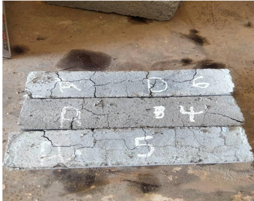
Figure:2.40: La texture des éprouvettes après le traitement thermique.
