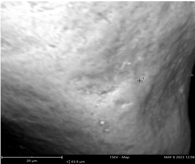
Figure 2.8: Image par microscopie électronique à balayage (MEB) du sable de dune
