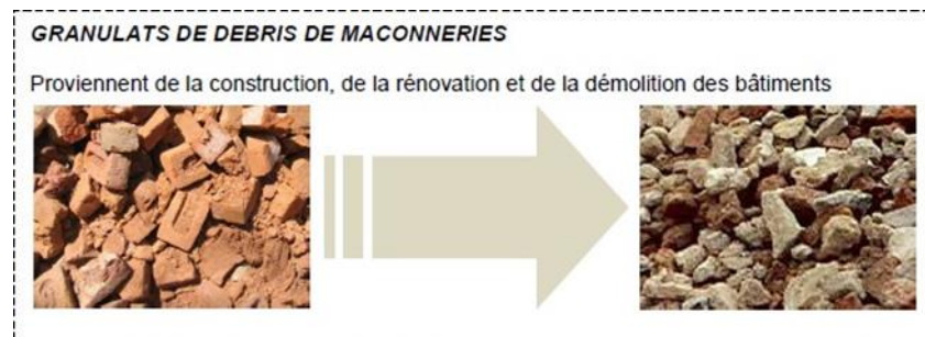
Figure 1.7 – Granulats recyclés de maçonnerie [9]
