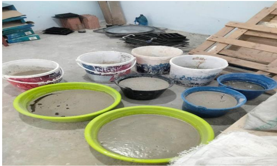
Figure 2.24 Le trempage du sable recyclé 0.63/4(2.5, 1.25 et 0.63 mm)
