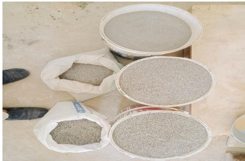
Figure 2.21. Les différentes fractions du sable recyclé 0.63/4(2.5,1.25 et 0.63 mm)
