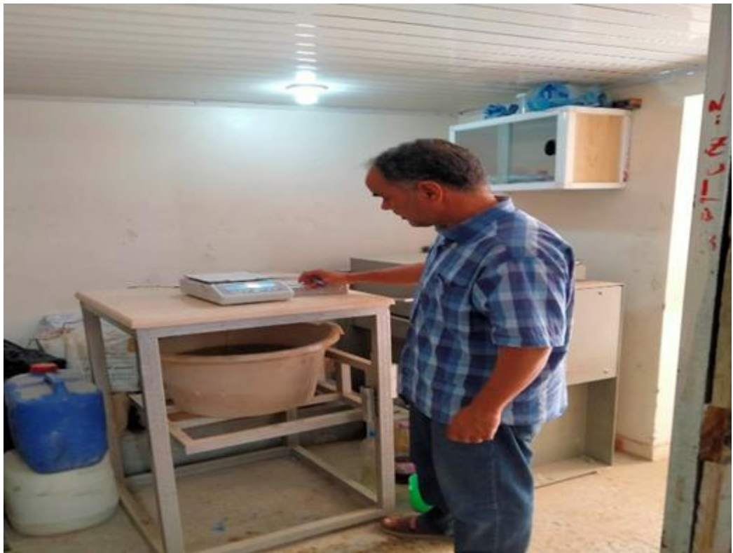
Figure2.34 Pesage hydrostatique des éprouvettes
