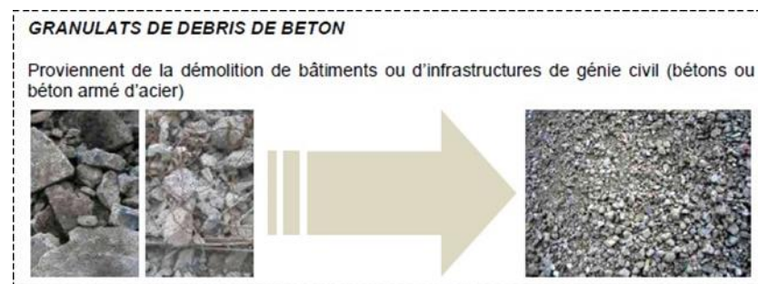
Figure 1.6 –Granulats recyclés de béton [9]
