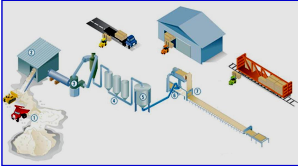
الشكل (I-22): رسم تخطيطي لمحطة انتاج الجبس [26].
