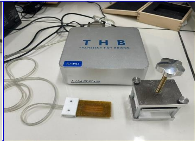
1- تنظيف مسبار التدفق الحراري بعد كل استعمال، لضمان دقة القياسات وسلامة تحضير العينات.
