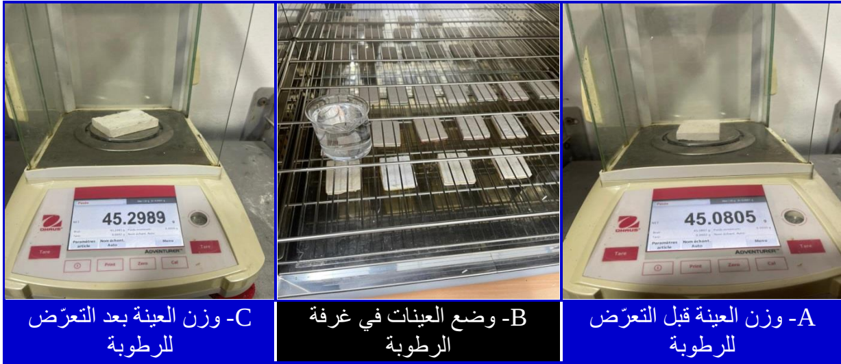
الشكل (III-15): مراحل إجراء تجربة الرطوبة.
