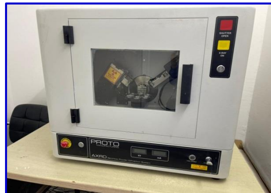
الشكل (III-3): جهاز انعراج الأشعة السينية.
