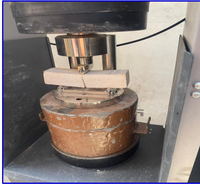
الشكل (II-12): العينة أثناء اختبار الانحناء.
