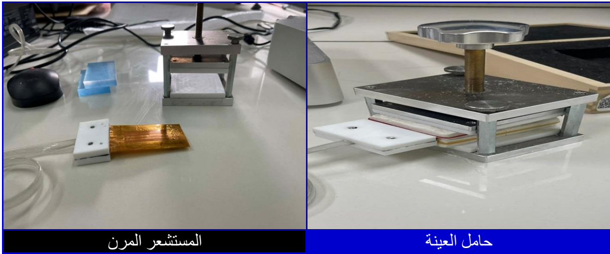
الشكل (II-10): جهاز قياس الناقلية الحرارية.
