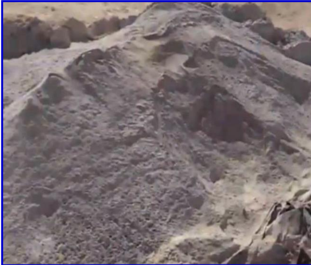
الشكل (I-21): صورة لجبس الفولية المكلس بالمازوت.
