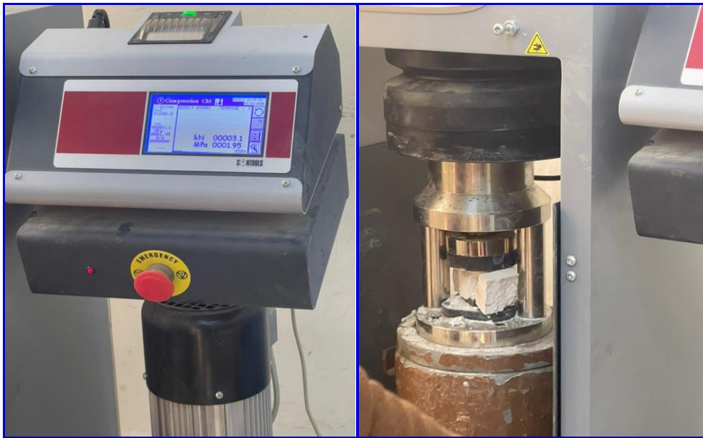
الشكل (III-13): آلة اختبار الضغط.
