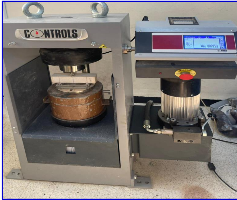
الشكل (II-11): صورة جهاز الضغط والانحناء.
