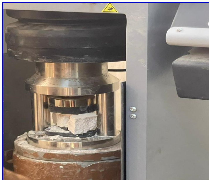
الشكل (II-13): العينة أثناء اختبار الضغط.
