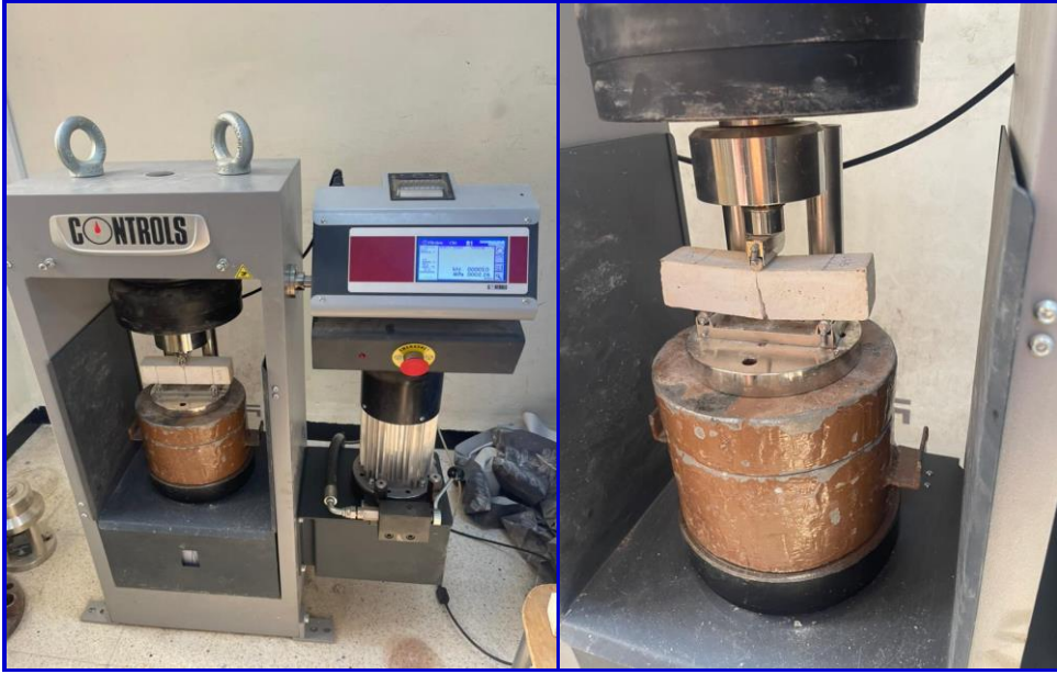
الشكل (III-12): آلة اختبار الانحناء.
