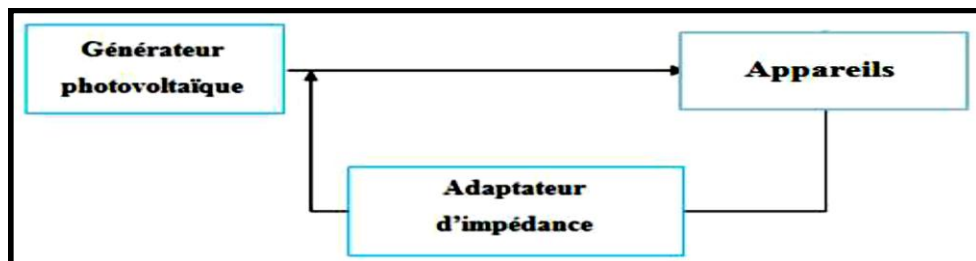
Figure. (I.9) : Schéma synoptique d'un système photovoltaïque à couplage direct
