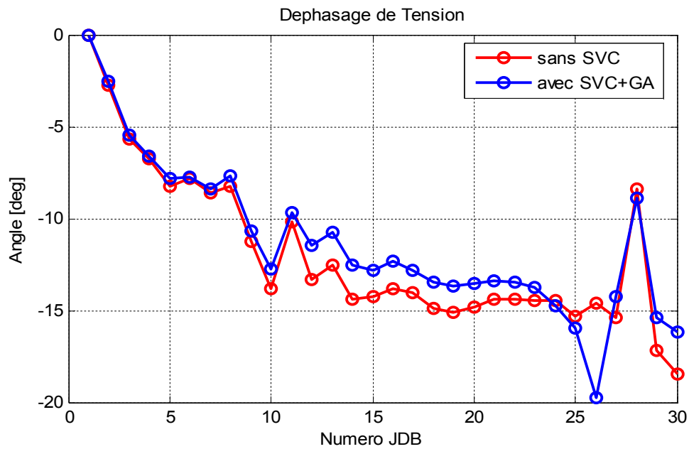
Figure IIV.9 Phases des tensions du réseau électrique à 30 jeux de barre
