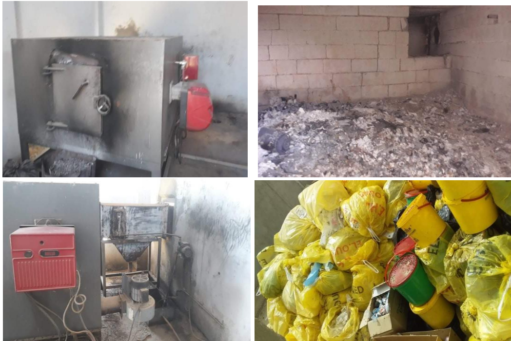
Figure N° 25: Machine d'incinération et les déchets spéciaux .
