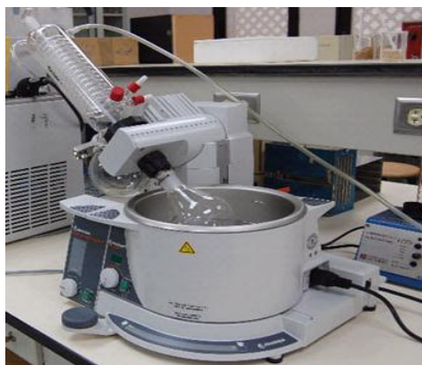
الشكل رقم 31.III: جهاز المبخر الدوار Rotary Evaporator .
