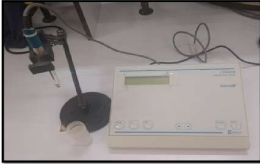
الشكل (3-4): جهاز قياس الناقلية الكهربائية.
