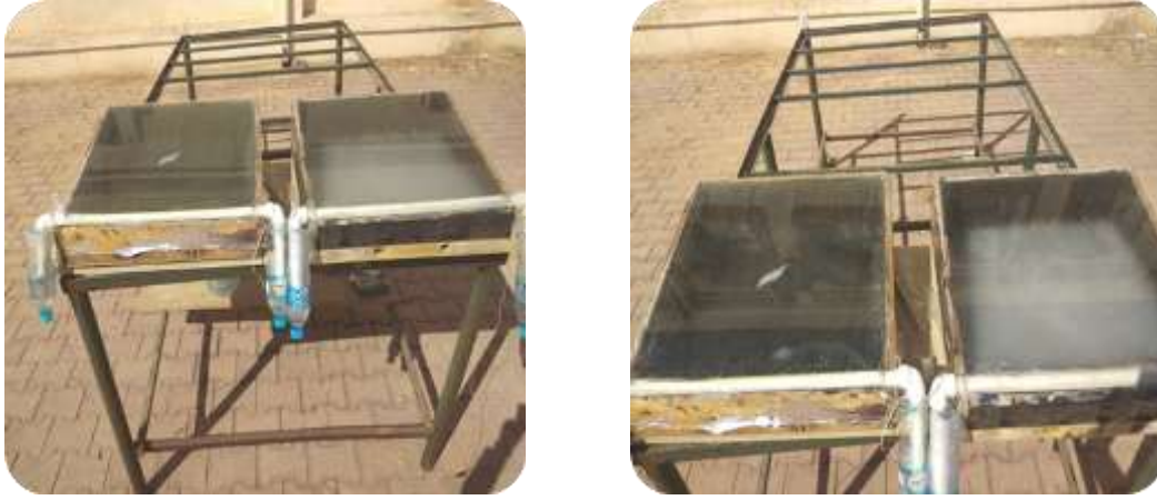
الشكل (3-9): المقطر الشمسي اثناء التجربة.
