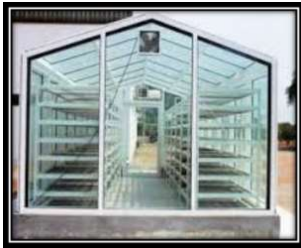
الشكل (1-4): استعمال الطاقة الشمسية في تجفيف المحاصيل الزراعية [46].
