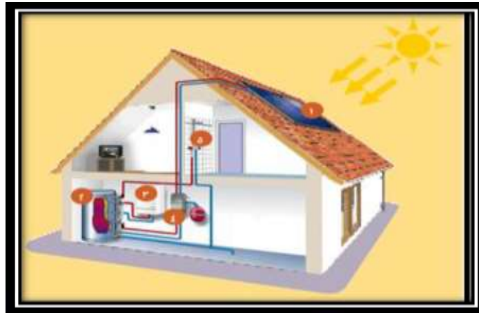
الشكل (1-8): نظام التدفئة الشمسية في المنازل [47].
