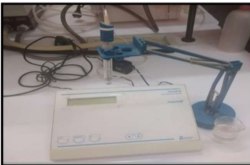
الشكل (3-3): جهاز قياس الـ pH متر.
