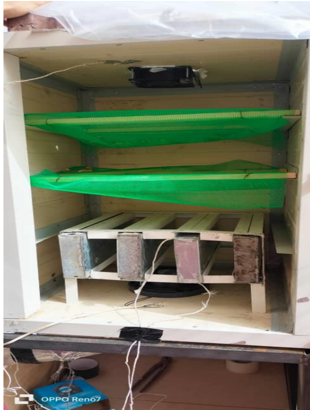
Figure III.5 : schéma de chembre de shésage pour le stokage de chaleur.
