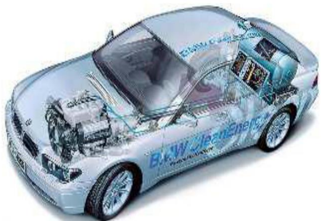
(b) Implantation d'un stockage cryogénique couplé à un moteur à combustion interne [7]
