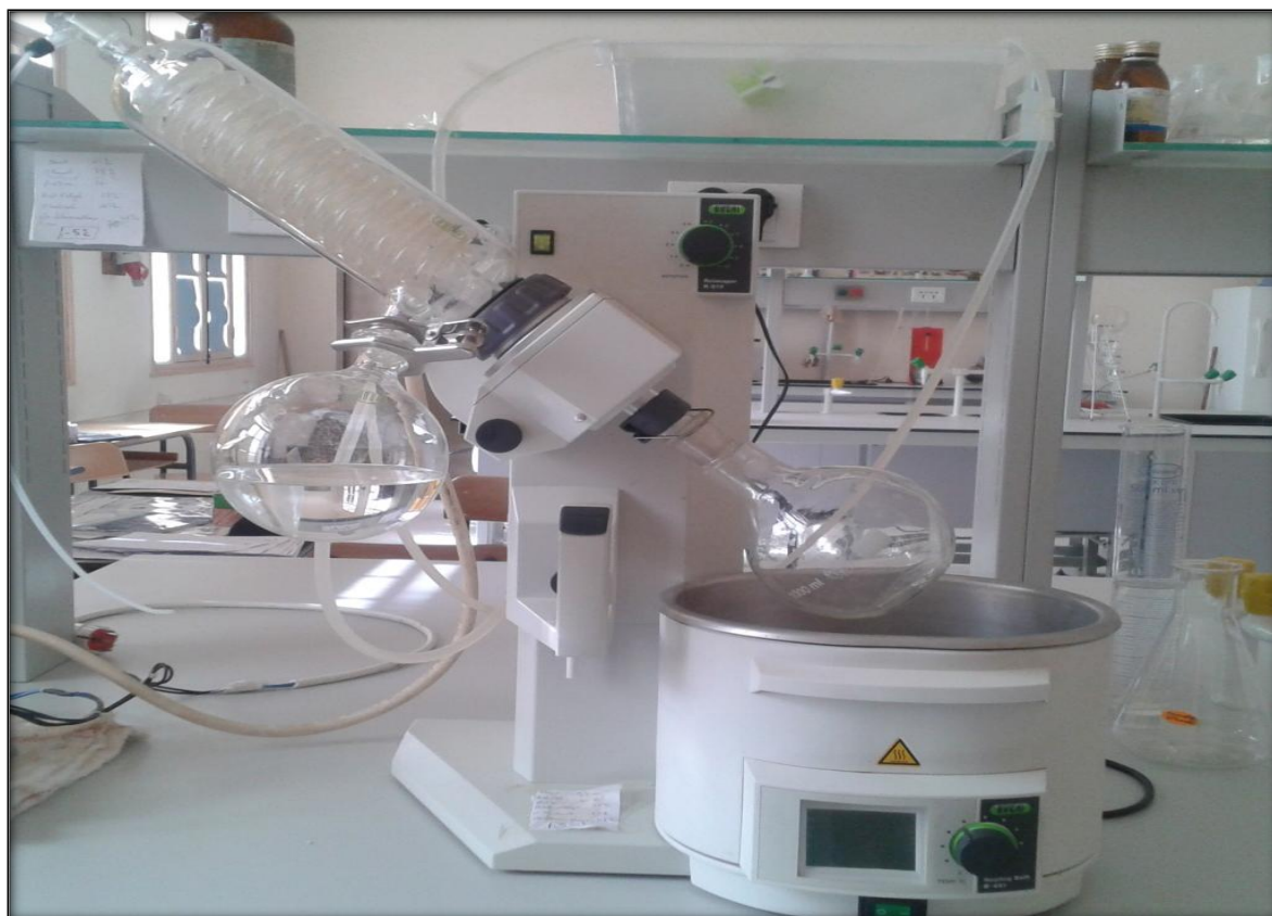
الوثيقة 10: جهاز Rotavapeur المستعمل في الدراسة (صورة فوتوغرافية أصلية).
