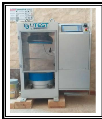
Figure II.21 : Machine d'essai de compression
