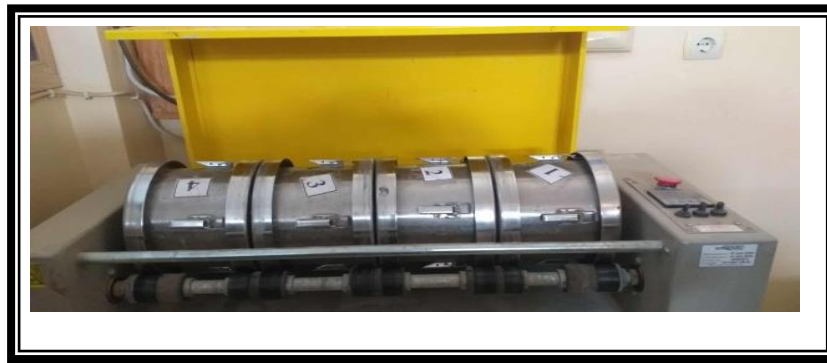
Figure II.11 : Processus de broyage des déchets céramiques
