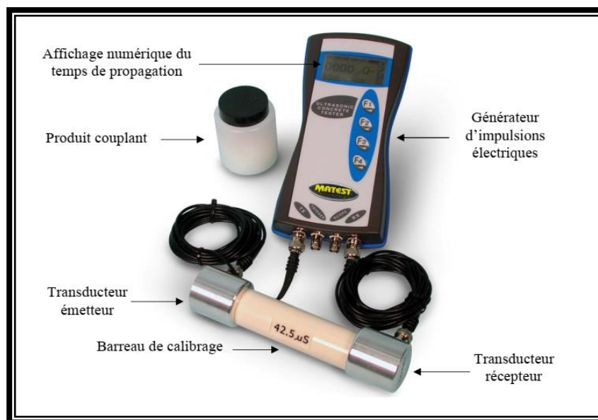
Figure II.32: Appareil d'auscultation sonique et ses accessoires.
