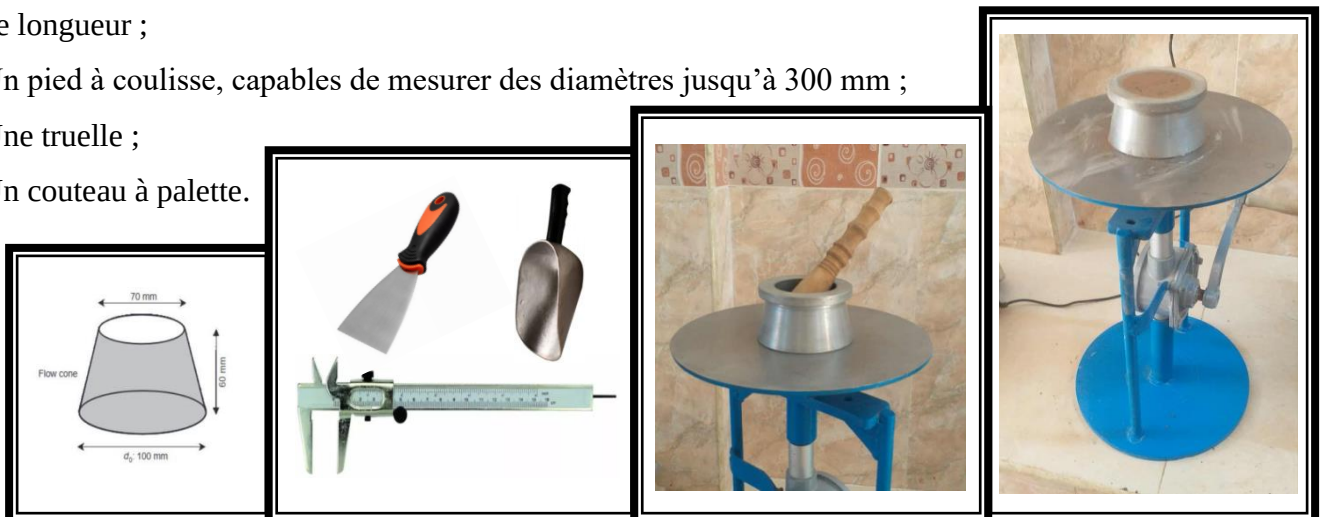
Figure II.16 : Equipement essai d'étalement à la table à secousse
