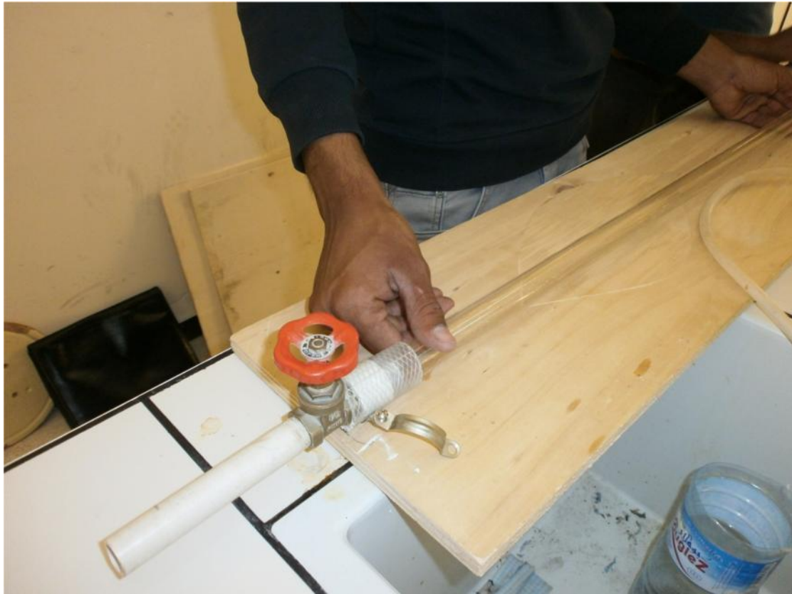
Figure II.5. l'emplacement du tube et de la vanne
