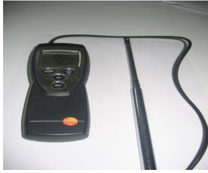
الشكل III.8. جهاز قياس سرعة الهواء.
