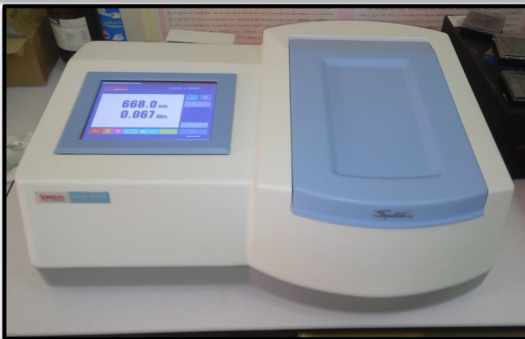
Figure III.6: Image d'un spectrophotomètre ultraviolet (SP-UV 500DB)
