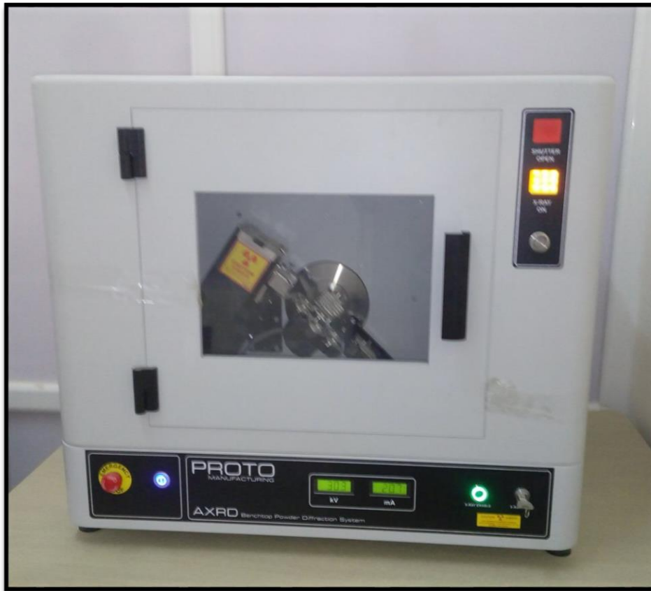
Figure III.2 : Image d'un diffractomètre de type (PROTO)
