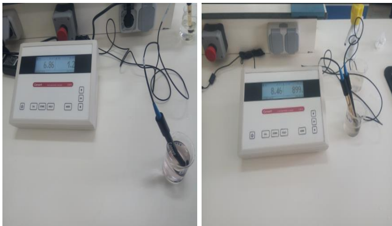
Figure 23. Mesure de pH et de conductivité électrique d'eau d'irrigation (Originale, 2020)
