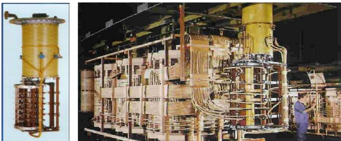
Figure I 10.Changeur de prise en charge
