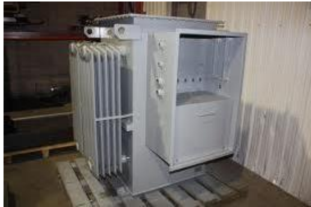
Figure I 7. cuve d'un transformateur.
