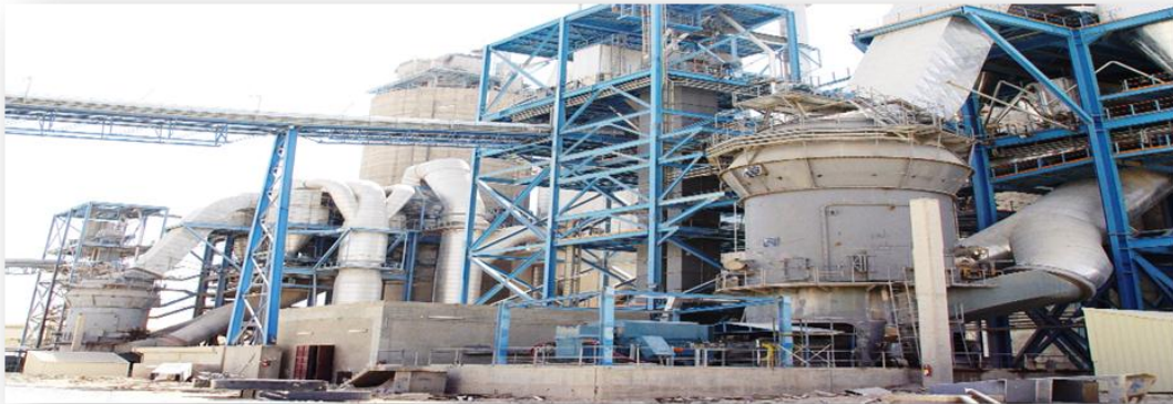
الشكل 08 : طاحونة ATOX للمواد الخام
