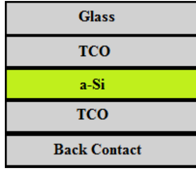
الشكل (11-1): هيكل الخلية الشمسية القياسية [32].
