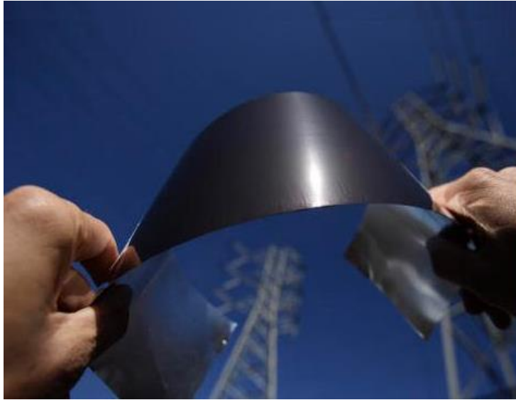
الشكل (10-1): خلية ذات أغشية رقيقة [27].
