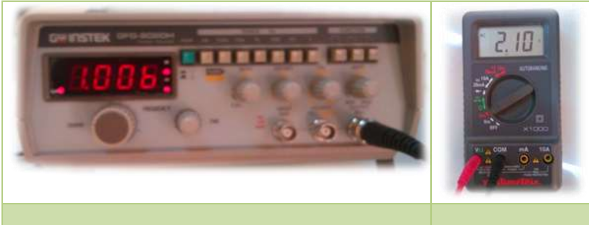
Figure 3.33 Les caractéristiques du signal d'entrée d'amplificateur classe C
