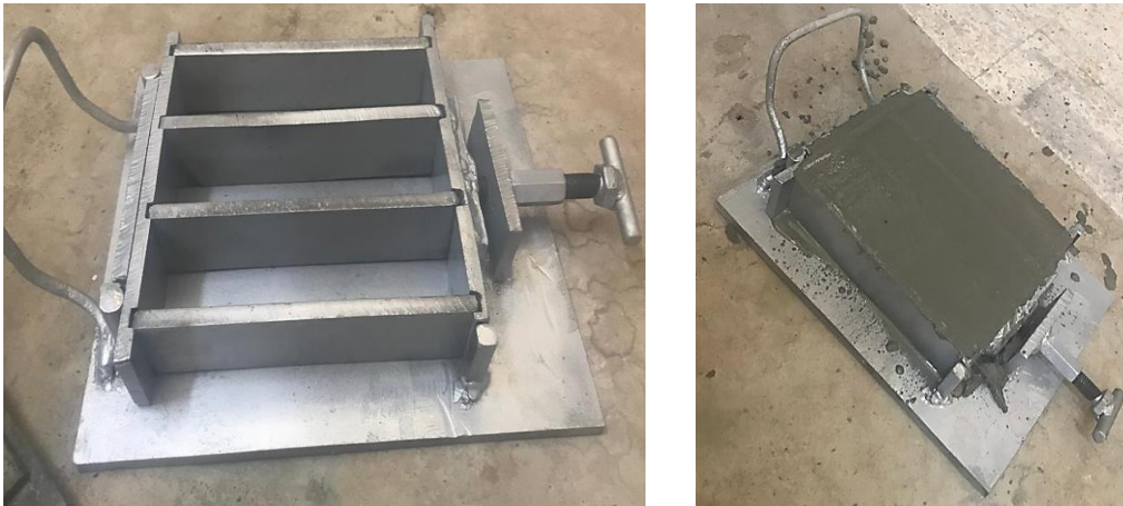
Figure 27 : Moule prismatique de mortier (40 × 40 × 160 mm)
