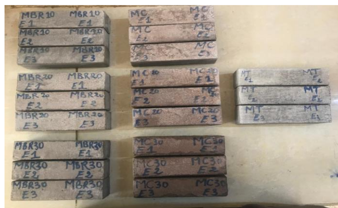
Figure 41 : Eprouvette soumises à la mesure de la masse volumique apparente
