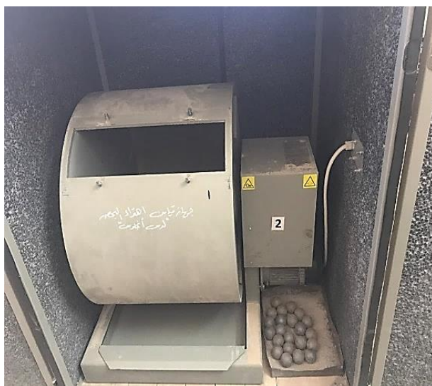
Figure 13. Appareil « Los Angeles » utilisé pour le broyage
