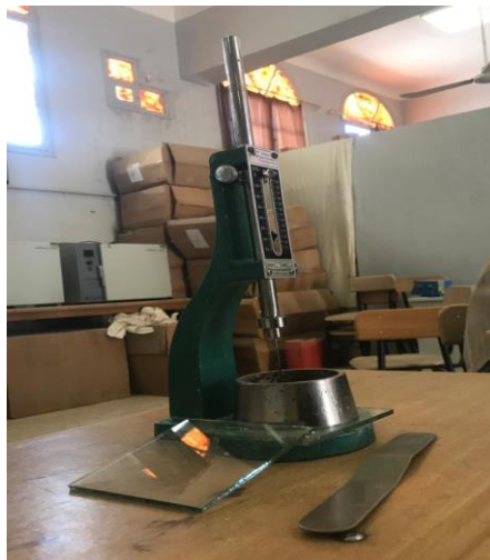
Figure 25. Appareil de vicat
