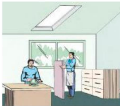
الشكل رقم (14): يوضح مصادر الضوء الطبيعي عبر النوافذ بالجدران والأسقف.
