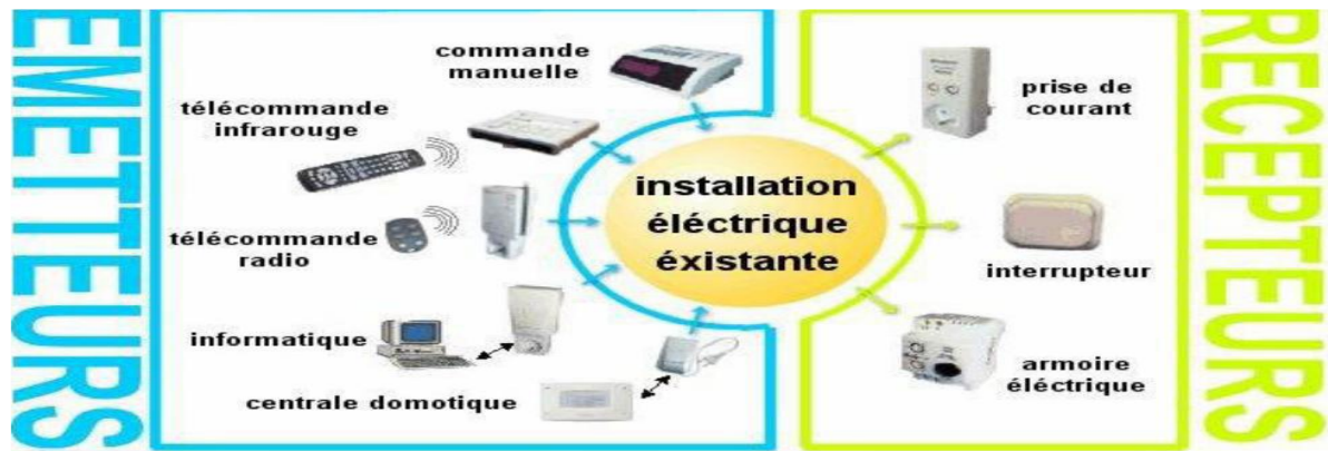
Figure I.13 : Présentation de la technologie du courant porteur en ligne[10].
