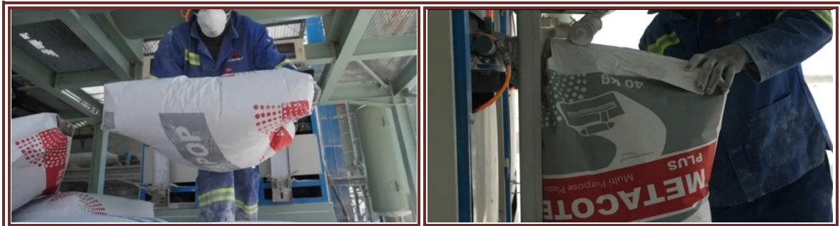
الشكل I-31 صورة تظهر تعبئة الجبس في أكياس [26].
