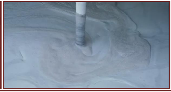
الشكل I-23 عملية غسل الجبس لنزع الشوائب [26].
