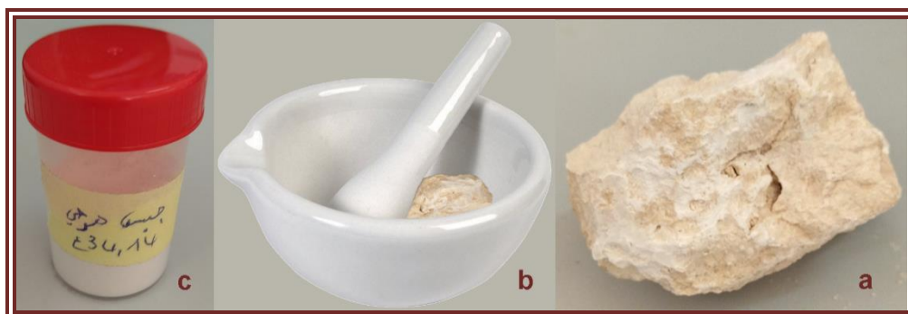
الشكل III-01 تحضير عينة من الحجر الجبسي لمنطقة الفولية (a) عينة لحجر جبسي من منطقة الفولية، (b) طحن العينة في الهاون (c) وضع الجبس المرحي في علبة
