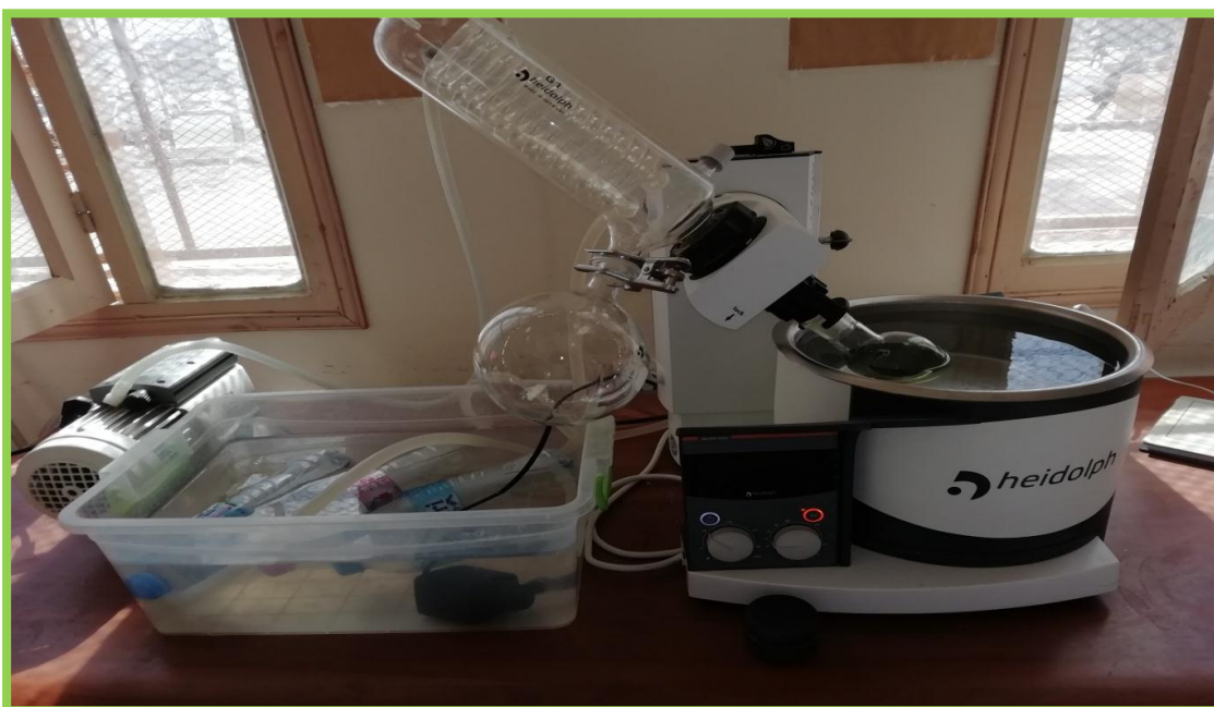
الشكل (3-IV): صورة جهاز Rotavapeur المستعمل في الدراسة (الصورة فوتوغرافية الأصلية )
