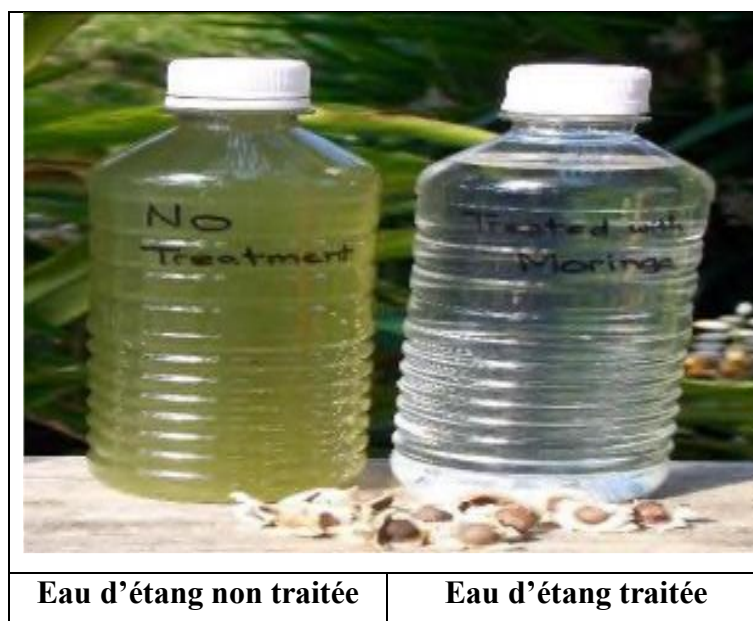
Figure I-02 : Purification de l'eau avec des graines de Moringa Oleifera .[35]
