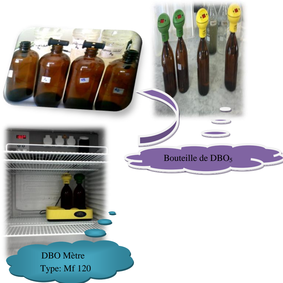
Figure 19: Matériel utilisé pour la détermination de la DBO
